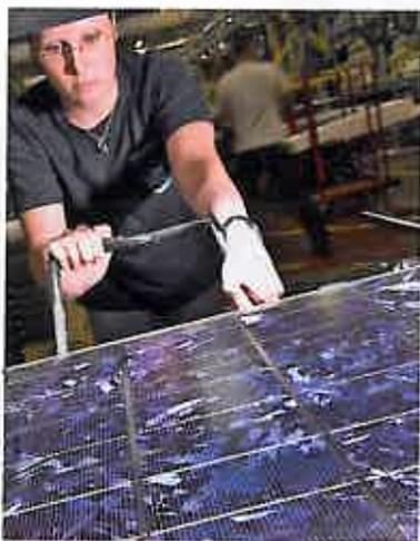
Le rendement énergétique des panneaux de photopiles en silicium est contrôlé avant leur conditionnement, dans l'usine Photowatt de Bourgoin-Jallieu, dans l'Isère.
