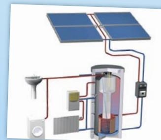
Une installation thermique permet de fournir entre 40 et 70 % des besoins en eau chaude (chauffe eau solaire) de l'habitat et de 30 à 50 % des besoins en chauffage suivant la région tout en étant écologique.
